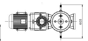
Diffuser Pump Body Strainer Basket Strainer Lid Lock Ring : GF Polypropylene : GF Polypropylene : Polypropylene : Polycarbonate : GF Noryl
